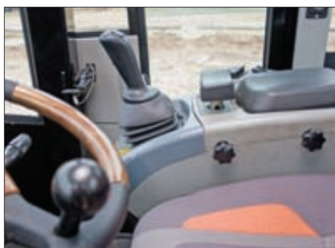
Rummelig kabine med joystick, som følger sædeindstillingen.
